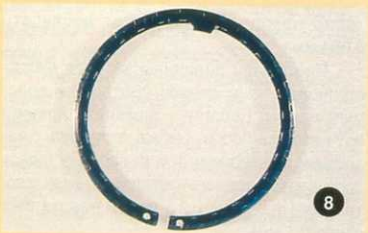
Фото 8. Изношенная стопорная шайба.
