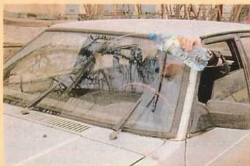
Замерзла вода, засорились жиклеры — вырчит бутылка с отверстием в пробке.
