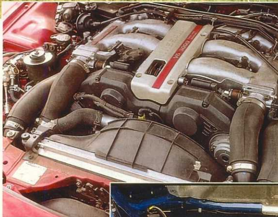
Очень близкие по характеристикам двигатели по-разному расположены в моторном отсеке: продольно у “Ниссана” и поперечно у “Мицубиси”.
