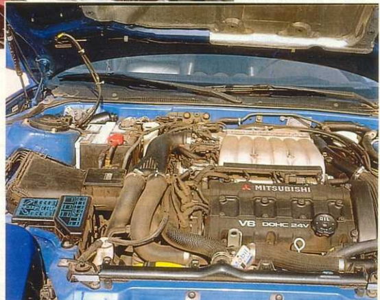
Очень близкие по характеристикам двигатели по-разному расположены в моторном отсеке: продольно у “Ниссана” и поперечно у “Мицубиси”.
