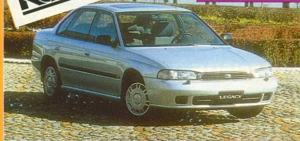
Новый участник "десятки" – "Субару-Легаси"; полный привод; двигатель: 2212 см 3 , 128 л. с./94 кВт; 195 км/ч.
