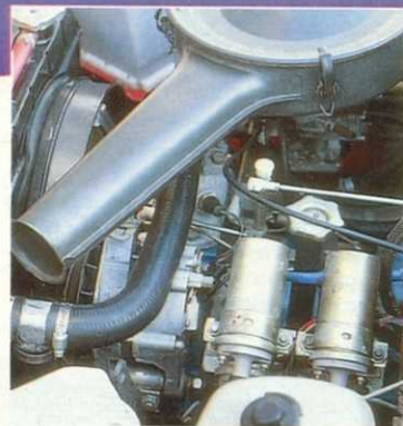
"Начинка" ВАЗ-21079. Хорошо видна двоямая катушка зажигания и увеличенный воздушный фильтр. Воздухозаборник большой длины снижает шум всасывания воздуха.
