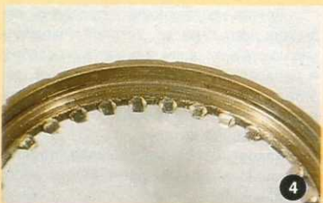
Фото 6. Состояние шлицев ведомой шестерни.
