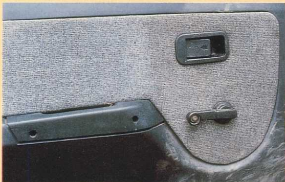
Водительская дверь "Таврии". Левая часть обработана препаратами фирмы "Turtle Wax" — для пластмассовых деталей и обивочных материалов. Правая половина осталась необработанной.
