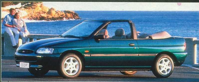
"Форд-Эскорт-Кабриолет" с двигателями объемом 1392–1796 см 3 , мощностью 73–130 л. с./54–96 кВт с двумя и четырьмя клапанами на цилиндр обладает хорошими динамическими качествами и предлагается по относительно невысокой цене.
