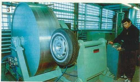
3 Готовые колеса испытывают на беговом барабане.
